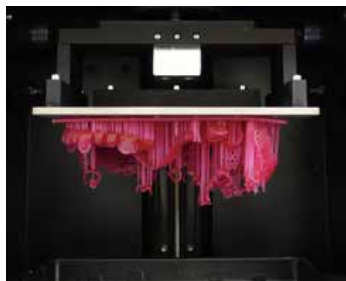
■ 図 19-46 ■ 液槽光重合方式による補綴装置の製作例(規制液面法でのSLA)
