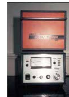
図 1-11 リングファーネス（電気加熱炉）
