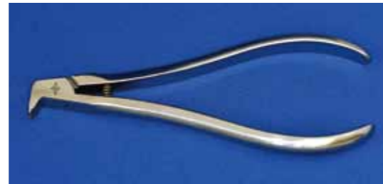
A: カーバイドバーにて金属冠に溝を入れたあと、先端部を溝に挿入して用いる
