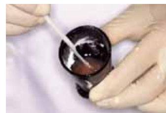
粉液の混和 必ず、液を入れた中に粉を入れる
